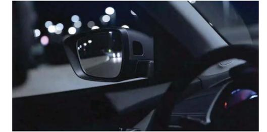
La función de detector de punto ciego utiliza sensores de radar de corto alcance que le advierte con un indicador en el espejo retrovisor lateral cuando hay vehículos en movimiento detectados en las zonas ciegas de su espejo lateral.
