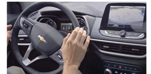
La función Asistente de estacionamiento automático ayuda a estacionar dirigiendo automáticamente el vehículo hacia un espacio de estacionamiento detectado mientras selecciona velocidades y realiza todas las aceleraciones de frenado.
