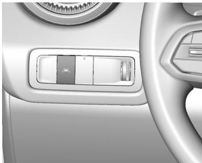
Para activar o desactivar el LKA, pulse
