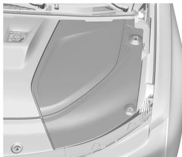
3. El depósito del refrigerante está debajo de las cubiertas de acceso debajo del capó. Para quitarlo, consulte *Cubiertas de acceso debajo del capó* ⇨ 252.
