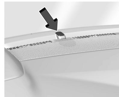
El sensor solar, en la parte superior del tablero de instrumentos cercano al parabrisas, monitorea el calor solar.
