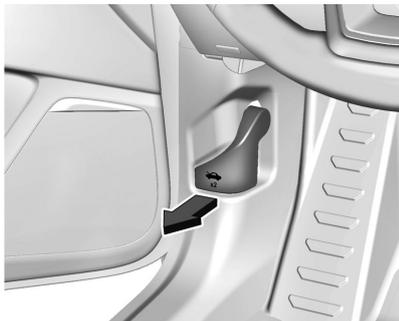
3. Suelte la palanca y vuelva a tirar de ella para abrir completamente el capó.
