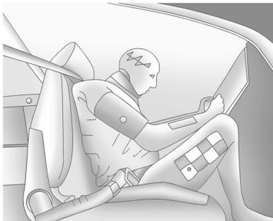
Cuando viaja en un vehículo, usted se desplaza a la misma velocidad que el vehículo. Si el vehículo se detiene súbitamente, usted sigue moviéndose hasta que algo lo detiene. ¡Puede ser el parabrisas, el tablero de instrumentos o los cinturones de seguridad!
