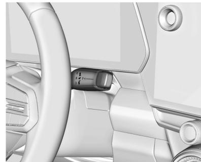
El vehículo utiliza una unidad eléctrica de accionamiento (Drive Unit). El patrón de cambios se muestra en la parte delantera de la palanca de cambios.
