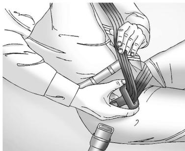
Si el cinturón se traba en la lengüeta metálica antes de llegar a la hebilla, incline la lengüeta hasta que quede plana para destrabar.
