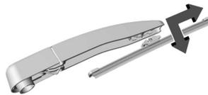
2. Al tiempo que sostiene el brazo del limpiaparabrisas, presione hacia abajo desde el extremo de la escobilla, en donde la escobilla encaja con el brazo, para separar ambos.
