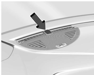
El indicador del tablero de instrumentos, junto al parabrisas, indica el estado del sistema.
