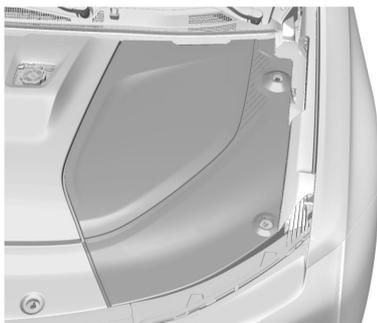
5. El terminal positivo (+) de la batería y el punto de puesta a masa negativo (-) se encuentran debajo de las cubiertas de
