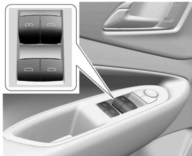
Pulse el interruptor para abrir la ventana. Tire hacia arriba la parte delantera del interruptor para cerrarla.
