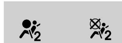
Los símbolos del indicador de estado del airbag del acompañante se encenderán durante algunos segundos como comprobación del sistema. Luego, después de varios segundos más, el indicador de estado se encenderá para informarle el estado del airbag frontal y el airbag para la rodilla del acompañante delantero. Consulte *Indicador de estado del airbag del pasajero* ⇨ 91.
