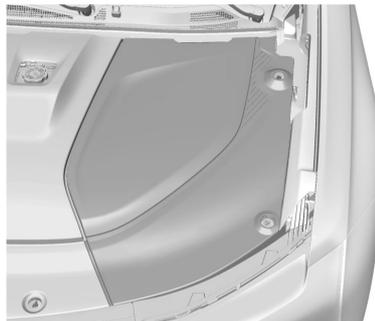
2. El liberador manual de emergencia del cable de carga está debajo de las cubiertas de acceso abajo del capó. Para quitarlo, consulte *Cubiertas de acceso debajo del capó* ⇨ 252.
