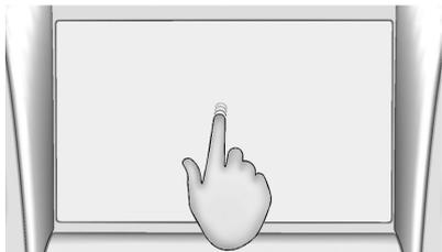
Desplazar se usa para mover elementos una distancia corta en una lista o sobre un mapa. Para desplazar, mantenga y mueva el elemento seleccionado hacia arriba o abajo a una ubicación nueva.
