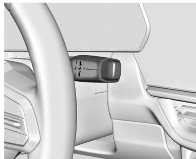
El vehículo utiliza una unidad eléctrica de **accionamiento (Drive Unit)**. El patrón de cambios se muestra en la parte delantera de la palanca de cambios. La posición de marcha seleccionada se iluminará en rojo en la palanca de cambios, mientras que todas las demás se mostrarán en blanco. Si el cambio no es inmediato, como en condiciones muy frías, el indicador en el interruptor de cambio puede parpadear hasta que esté completamente enganchado.
