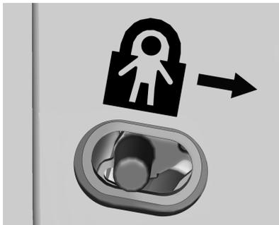
La traba de seguridad se encuentra en los bordes interiores de las puertas traseras. Para utilizar la cerradura de seguridad:
