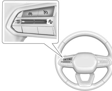
⊕/⊖ : Púlselo para encender o apagar el sistema. El testigo se vuelve blanco en el cuadro de instrumentos cuando el ACC está activado.
