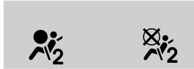
Los símbolos del indicador de estado del airbag del acompañante se encenderán durante algunos segundos como comprobación del sistema. Luego, después de varios segundos más, el indicador de estado se encenderá para informarle el estado del airbag frontal y el airbag para la rodilla del acompañante delantero. Consulte *Indicador de estado del airbag del pasajero* ⇨ 93.
