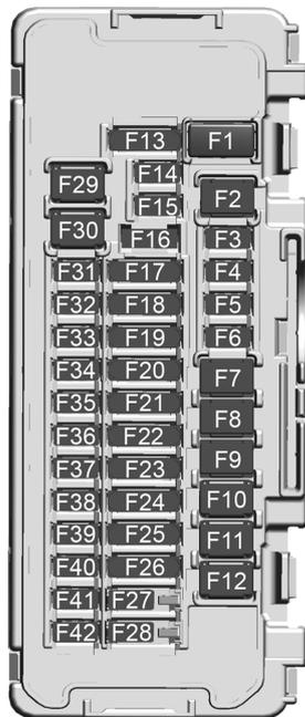
El vehículo puede no estar equipado con todos los fusibles y las funciones que se muestran.
