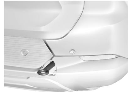
2. Coloque la argolla de remolque en el zócalo y gírela hasta que quede completamente apretada. Cuando se desmonte la argolla de remolque, vuelva a colocar la tapa con la muesca en la posición original.
