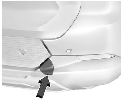
1. Abra cuidadosamente la tapa de la facia utilizando la ranura pequeña que oculta el zócalo de la argolla de remolque.
