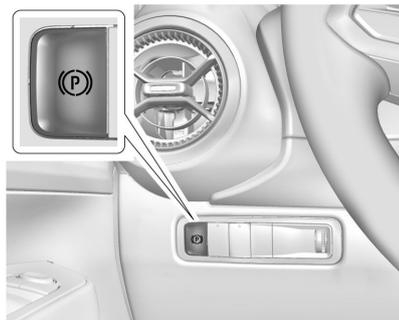
El Freno de estacionamiento eléctrico (EPB) puede estar siempre aplicado, incluso si el vehículo está apagado. En caso de alimentación eléctrica insuficiente, el EPB no puede ser aplicado o liberado. Para evitar que se agote la batería, evite ciclos repetidos innecesarios del EPB.
