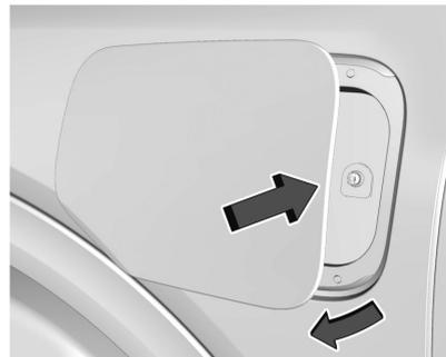
2. Presione el borde trasero de la puerta del puerto de carga y suéltelo para abrirla. En condiciones de tiempo frío, puede formarse hielo alrededor de la tapa del puerto de carga. Quite el hielo de la zona antes de intentar abrir o cerrar la tapa del puerto de carga.
