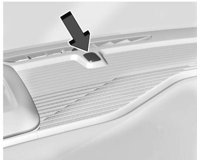
El sensor de luz está sobre el tablero de instrumentos. No cubra el sensor.
