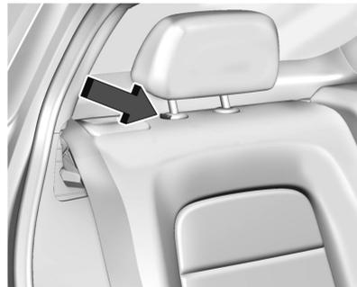
Para bajar el apoyacabezas, presione el botón en la parte superior del respaldo y empuje el apoyacabezas hacia abajo. Intente mover el apoyacabezas después de soltar el botón para estar seguro de que se trabó en su lugar.
