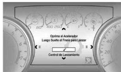
10. Presione el pedal a fondo rápidamente. Libere el pedal del freno para lanzar el vehículo.
