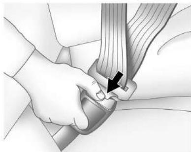
Para abrir el cinturón, presione el botón de la hebilla. El cinturón debe volver a la posición de guardado.
