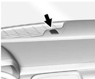
La luz de seguridad, en el tablero de instrumentos junto al parabrisas, indica el estado del sistema:
