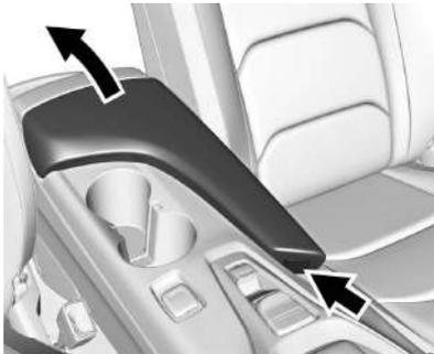
Pulse para abrir. Si están equipados, hay dos puertos USB y un toma auxiliar en el interior. Consulte *Puerto USB* ⇨ 120 y *Gato auxiliar* ⇨ 123.
