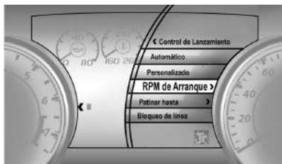
6. Desplácese hasta r.p.m. de salida usando ▽.
