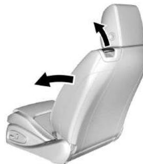
Para llegar a los asientos traseros, tire hacia arriba de la traba en la parte superior del respaldo del conductor o del acompañante delantero. Pliegue el respaldo hacia adelante.
