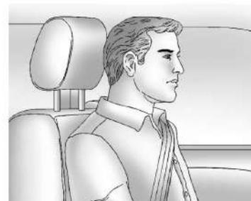
Ajuste el apoyacabezas de modo tal que su parte superior esté a la misma altura que la parte superior de la cabeza del ocupante. Esta posición reduce la probabilidad de una lesión de cuello en un choque.
