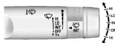
La palanca del limpia/lavaparabrisas está en el costado derecho de la columna de dirección. Con el encendido en contacto o en ACC/ACCESORY (ACCESORIO), mueva la palanca del limpiaparabrisas para seleccionar la velocidad del mismo.
