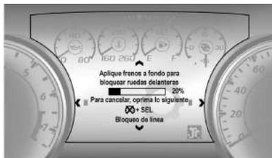
6. Pulse firmemente el pedal del freno para que el gráfico de barras pase al 100%.
