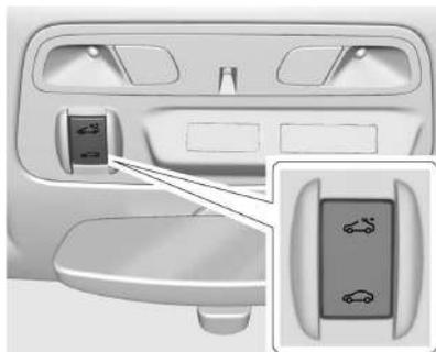
Si está equipado, el techo solar solo funciona cuando el encendido está conectado o en la posición ACC/ACCESSORY, cuando la alimentación retenida para accesorios (RAP) está activa. Vea *Alimentación de accesorios retenida (RAP)* → 196.
