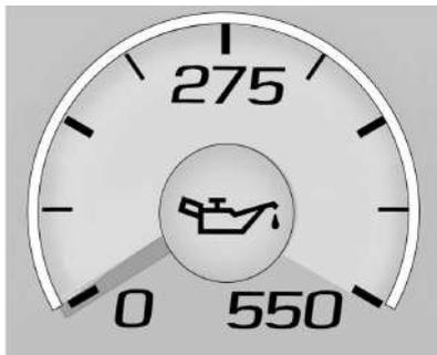
El manómetro de aceite del motor muestra la presión del aceite en el motor en kPa (kilopascal) con el motor funcionando.
