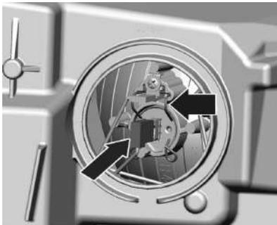
2. Desenchufe el conector de la lámpara.
