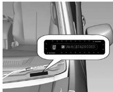
El número de identificación del vehículo está grabado en el tablero de instrumentos, visible a través del parabrisas.
