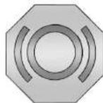
El tapón del depósito de líquido de frenos/embrague hidráulico tiene este símbolo. El depósito del líquido de frenos/embrague común se llena con líquido de frenos DOT 4LV, tal como se indica en el tapón del depósito. Vea la ubicación del depósito en *Vista del compartimento del motor* ⇨ 233.
