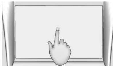
La función de desplazar se usa para mover elementos una distancia corta en una lista o sobre un mapa (si está disponible). Para desplazar, mantenga y mueva el elemento seleccionado hacia arriba o abajo a una ubicación nueva.
