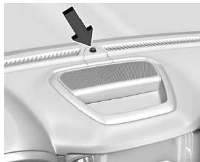
El vehículo cuenta con un sensor de luz en la parte superior del tablero de instrumentos, el cual controla el sistema automático de faros. No cubra el sensor, de lo contrario se podrían encender los faros cuando no sean necesarios.
