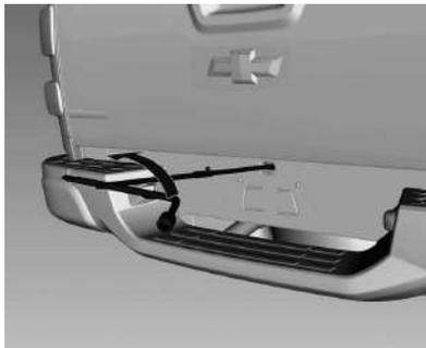
3. Gire la llave de ruedas en sentido antihorario para bajar el neumático de auxilio hasta el suelo. Continúe girando la llave de ruedas hasta que el neumático de auxilio se pueda extraer desde abajo del vehículo.
