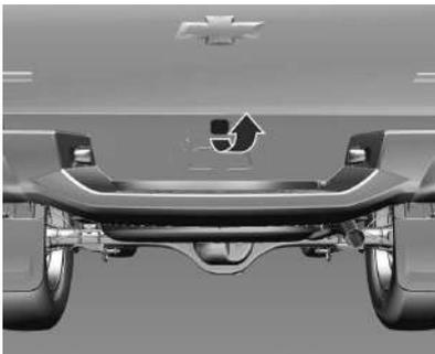
2. Retire la cubierta para insertar el extremo biselado de la manivela del gato con un ligero ángulo a través del orificio central en el paragolpes trasero y hacia adentro de la guía con forma de embudo.
