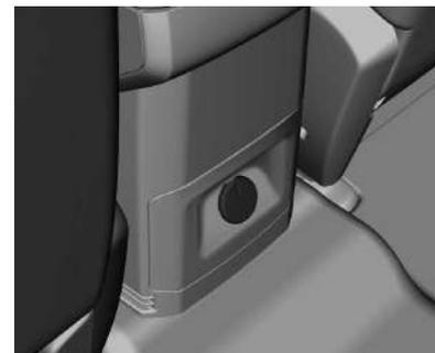
La toma de tensión de 12V está en la parte trasera de la consola central delantera.
