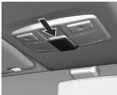
Hay un sujetador de ticket de estacionamiento en el medio de las luces de lectura y los interruptores. Para usarlo, tírelo hacia abajo con cuidado y coloque el ticket.
