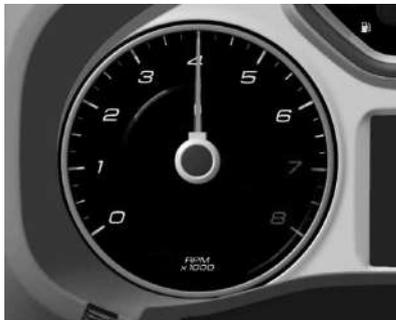
Indica las revoluciones por minuto del motor (rpm).
