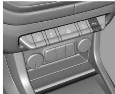
El botón **P** del tablero de instrumentos se usa para activar o desactivar la asistencia para estacionamiento delantera y trasera. El LED indicador junto al botón se enciende cuando las funciones están activadas, y se apaga cuando se han inhabilitado las funciones.
