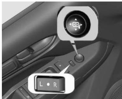
Mueva el interruptor de selección a **L** (izquierda) o a **R** (derecha) para seleccionar el espejo del conductor o del acompañante. Mueva el espejo a la dirección deseada pulsando el interruptor de cuatro direcciones.
