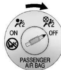
Si el tablero de instrumentos tiene el interruptor que se muestra en la ilustración, el vehículo cuenta con un interruptor de activación/desactivación de los airbags que se puede usar para activar o desactivar manualmente el airbag del acompañante.
