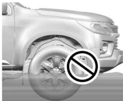
Atraviese la zona inundada a baja velocidad y asegúrese de que el nivel del agua no supere la altura de media rueda.
