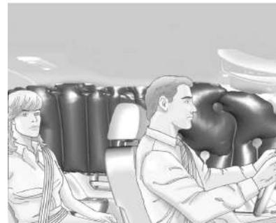
Si el vehículo cuenta con airbags en las barras del techo para el conductor, el acompañante delantero lateral y los pasajeros laterales del asiento trasero, los mismos se encuentran en el techo, sobre las ventanas laterales.
