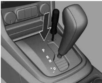
3. Inserte un destornillador en el orificio hasta que se desbloquee la palanca, saque la palanca selectora de la posición P y muévela a la posición N.
