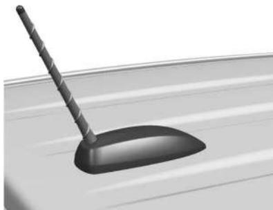
Para desmontar la antena del techo, gírela hacia la izquierda. Para instalar la antena del techo, gírela hacia la derecha.
