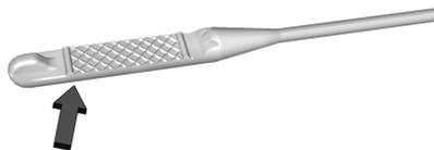
Si el aceite está por debajo del área con rayas cruzadas en la punta de la varilla de medición y el motor ha estado apagado como mínimo 15 minutos, agregue 1 L (1 qt) del aceite recomendado y luego vuelva a comprobar el nivel. Consulte "Selección del aceite correcto para el motor" más adelante en esta sección para ver la explicación acerca de la clase de aceite a usar. Para conocer la capacidad del cárter de aceite del motor, consulte *Capacidades y especificaciones* ⇨ 48.
