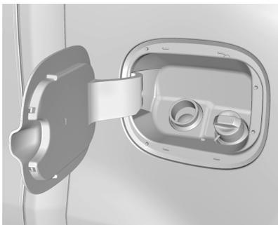
Para abrir la tapa de combustible, empuje y suelte del borde central trasero de la tapa. El sistema de recarga sin tapa no cuenta con una tapa para el tubo de recarga. Inserte completamente y trabe la boquilla de recarga, luego comience a recargar.
