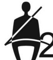
La luz de advertencia del cinturón de seguridad se enciende si el asiento del acompañante está ocupado y el ocupante no se ha abrochado el cinturón de seguridad correctamente luego de haber puesto en contacto el encendido. A continuación, si el acompañante delantero no se abrocha correctamente el cinturón de seguridad, ocurrirán los siguientes eventos:
