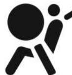
La luz de advertencia del airbag se enciende cuando se pone en contacto el encendido y se apaga después de unos segundos. Esto indica que tanto la luz de advertencia y como el sistema del airbag están funcionando normalmente.
