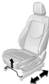
Tire hacia arriba la palanca de ajuste que se encuentra en la parte delantera inferior del asiento para ajustar el mismo hacia adelante o hacia atrás, y suéltela una vez que haya ajustado el asiento en la posición correcta.
