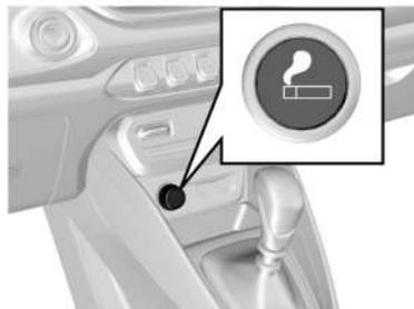
El encendedor está ubicado debajo de la parte central del tablero. Para usar el encendedor, gire el encendido a la posición ACC (ACCESORIOS) u ON (ENCENDIDO) y luego presione el encendedor hasta el fondo. El encendedor se eyectará automáticamente cuando esté listo.
