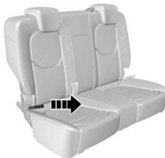
Hay correas para el destrabado del respaldo en los laterales izquierdo y derecho de los asientos traseros 60/40. Tire de las mismas para destrabar el respaldo correspondiente.
