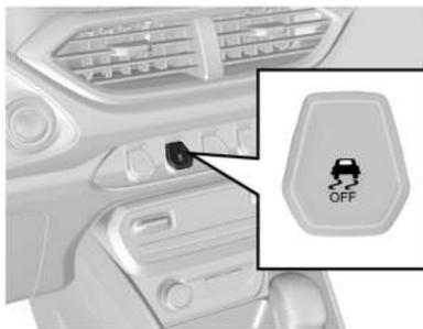
Pulse el interruptor ESC OFF (DESACTIVADO); se encenderá la luz ESC OFF del cuadro de instrumentos y algunas funciones del ESC quedarán deshabilitadas. Presione nuevamente el interruptor ESC y se habilitará nuevamente la función ESC. La lámpara ESC OFF del cuadro de instrumentos se apagará.
