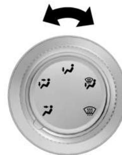
Ajuste la perilla de distribución de aire al modo deseado, de manera que el aire fluya en la dirección deseada. La perilla de distribución del aire se puede establecer en una de las siguientes cinco posiciones:
