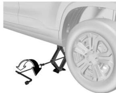
5. Gire la biela del gato hacia la derecha para permitir que el gato suba lentamente y asegúrese de que la cabeza del gato esté firmemente puesta en la posición de elevación.
