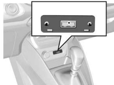
El puerto USB del toma auxiliar delantero está ubicado debajo de la parte central del tablero.
