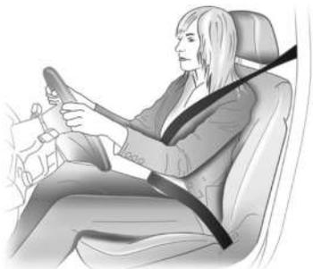
El cinturón de seguridad está diseñado para un solo pasajero. No es apto para pasajeros menores de 12 años de edad o de una estatura inferior a los 150 cm. Revise periódicamente todas las partes del sistema del cinturón de seguridad para verificar que no tenga daños y que no funcione de forma anormal. Reemplace las partes y componentes dañados. Para reemplazar o realizar un servicio a un cinturón de seguridad, consulte con su concesionario.
