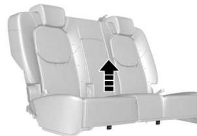
Tire levemente de la parte delantera del cojín del asiento para destrabarlo y levántelo.
