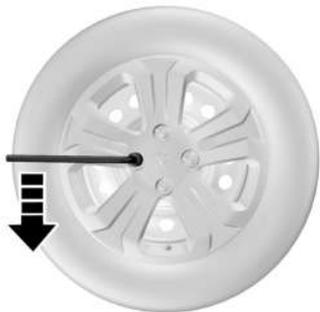
1. Utilice una llave de vaso para aflojar una vuelta la tuerca de rueda.
