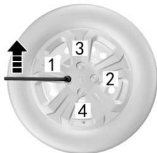
12. Ajuste las tuercas de la rueda siguiendo la secuencia de 1-2-3-4 que se muestra arriba. El valor del par es de 90-100 Nm
