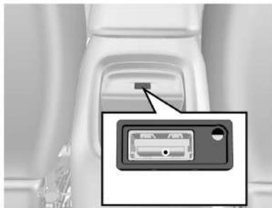
Si el vehículo está equipado con un puerto USB auxiliar trasero (5V), el mismo se encuentra en la parte trasera de la consola. Se puede usar para cargar teléfonos móviles, con una corriente máxima de carga de 1A. El puerto no funciona cuando el encendido está desconectado.
