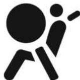
En el tablero de instrumentos hay una luz testigo de los airbags que se distingue con el símbolo con la forma de los airbags. El sistema comprobará si el sistema del circuito de los airbags tiene una falla y dará el correspondiente aviso por medio del testigo. Consulte el capítulo "Instrumentos y controles" para obtener información detallada.
