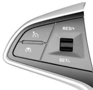
Los botones de control de velocidad crucero están en el volante. Cuando se inicia el sistema de control de velocidad crucero, el vehículo puede funcionar a la velocidad fijada. Pise el pedal de freno y la función será desactivada de inmediato. Además de usar el pedal del freno para deshabilitar la función, también se pueden usar los
