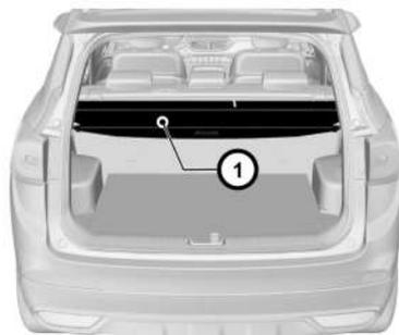
La cubierta se usa para proteger los objetos en el compartimiento de carga.
