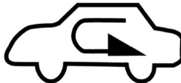
Cuando se pone en contacto el encendido, pulse este botón para cambiar entre los modos de recirculación de aire interior y de entrada de aire exterior. Cuando se está usando el modo de recirculación de aire interior, se enciende el testigo debajo del botón de recirculación del aire.
