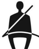
La luz de advertencia del cinturón de seguridad se enciende si el conductor no se abrocha el cinturón de seguridad correctamente luego de poner en contacto el encendido. A continuación, si el conductor no se abrocha correctamente el cinturón de seguridad, ocurrirán los siguientes eventos:
