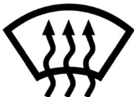
Pulse el botón del desempañador delantero para activar el modo de desempañado del parabrisas. El testigo debajo del botón se enciende, la circulación del aire se ajusta automáticamente al ingreso de aire exterior, el aire acondicionado (A/C) se enciende y el ventilador se ajusta automáticamente a la "4.ª velocidad". Si el caudal de aire ya está por encima del nivel 4 antes de pulsar el botón, permanecerá en su nivel.
