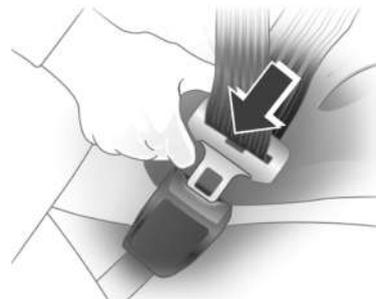
Retire el cinturón de seguridad del retractor, guíelo alrededor del cuerpo sin retorcerlo e inserte la lengüeta de bloqueo en la hebilla para abrocharlo. Para conducir, tire de la banda torácica con fuerza para ajustar la tensión de la banda de la cadera.
