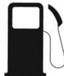
Esta luz de advertencia se enciende inmediatamente cuando se pone en contacto el encendido. Esto indica que el sistema está llevando a cabo una autoinspección y que la lámpara de la luz de advertencia está funcionando correctamente. Si esta luz permanece encendida luego de poner en contacto el encendido o se enciende mientras conduce, indica que hay insuficiente cantidad de combustible en el tanque y debería cargar combustible a tiempo.
