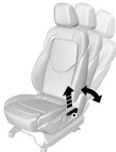
Tire la palanca hacia arriba y ajuste el ángulo de inclinación del respaldo a la posición adecuada, y luego suelte la palanca. No se apoye en el respaldo mientras lo ajusta. Luego de ajustar el respaldo, recuéstese sobre el mismo para asegurarse de que se haya trabado en su posición.
