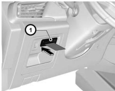
En la parte izquierda del tablero de instrumentos, hay una ranura para colocar tarjetas.
