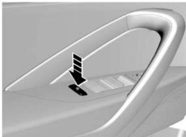
El botón de bloqueo de la ventana eléctrica se puede pulsar para bloquear las ventanas traseras y el interruptor de la ventana del acompañante delantero. Cuando se pulsa el botón, las ventanas traseras y la ventana del acompañante delantero solo se pueden controlar usando el panel de control de ventanas que se encuentra en la puerta del conductor. Púlselo nuevamente para desbloquear.
