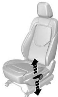
Para ajustar la posición del cojín del asiento del conductor, levante o baje la manija que se encuentra al costado del cojín del asiento hasta llegar a la posición deseada. Para ajustar la altura del asiento del conductor, el asiento debe estar cargado. De lo contrario, se podría dañar el dispositivo de ajuste.
