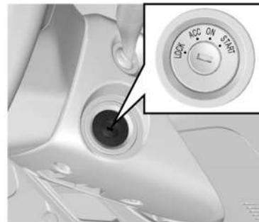
Cuando se gira el encendido que está a la derecha de la columna de dirección, las posiciones de funcionamiento son:
