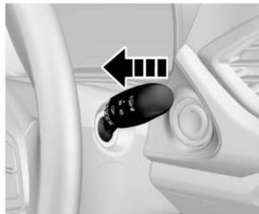
Para pulverizar líquido de lavado sobre el parabrisas:
