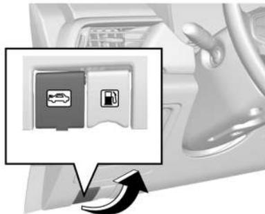
1. Tire de la palanca de liberación del capó que se encuentra en el lateral inferior izquierdo del tablero de instrumentos. El capó se abrirá parcialmente.
