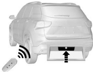
Cuando las puertas están bloqueadas, el encendido está en la posición LOCK (BLOQUEO) y el transmisor RKE está a una distancia inferior a 1,2 m de la compuerta levadiza, al pulsar el botón de liberación de la misma, ésta se desbloqueará. La compuerta levadiza se abrirá
