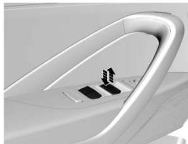
Para levantar el vidrio de la ventana, tire del interruptor hacia arriba.
