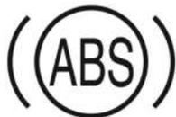
La luz de advertencia del ABS se enciende inmediatamente cuando se pone en contacto el encendido. Esto indica que el sistema está llevando a cabo una autoinspección y que la lámpara de la luz de advertencia está funcionando correctamente. La luz de advertencia se apaga luego de varios segundos.
