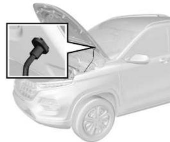
3. Quite la varilla de soporte del capó de su abrazadera. Levante la varilla de soporte e inserte firmemente el extremo libre en la ranura que se encuentra en el capó.
