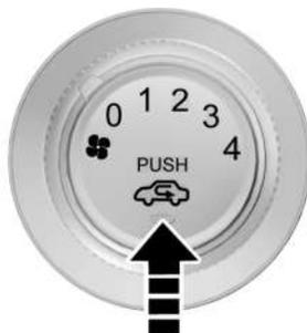
Puede pulsar este botón cuando conduce por una carretera polvorienta, o cuando desee evitar que entren gases de escape o humo del exterior, o cuando desee bajar o subir rápidamente la temperatura en la cabina de pasajeros. Se enciende el testigo en el botón y el aire dentro del vehículo recircula internamente.
