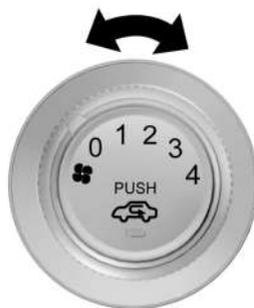
Gire la perilla de control de velocidad del ventilador para controlar el caudal de aire del sistema. Gire la perilla hacia la derecha para aumentar la velocidad del ventilador o hacia la izquierda para disminuir la velocidad del ventilador.
