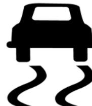
La luz de advertencia se enciende luego de que se pone en contacto el encendido y se apaga después de unos segundos. Esto indica que la luz de advertencia está funcionando normalmente.
