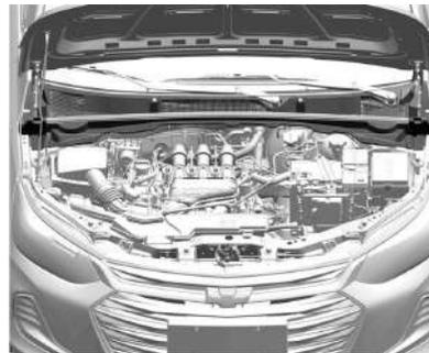
La entrada de aire en el compartimento del motor, delante del parabrisas, debe estar libre para permitir la entrada de aire. Retire cualquier resto de hojas, suciedad o nieve.
