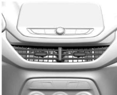
Use las aletas de las rejillas de las salidas de aire para cambiar la dirección del flujo de aire.
