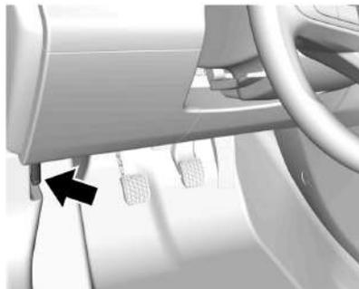
Tire de la palanca de liberación del capó. Está dentro del vehículo, a la izquierda de la columna de dirección.
