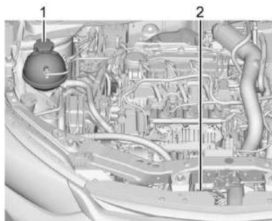
Se muestra el tanque de compensación del refrigerante para el motor L3 1.0L Turbo; los demás son similares
