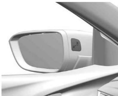
Cuando la velocidad del vehículo supera los 10 km/h, se activa el sistema de alarma del punto ciego lateral. Cuando la velocidad del vehículo es superior a los 140 km/h, se desactiva el sistema y se atenúan las luces indicadoras de los espejos derecho e izquierdo. En este punto, si se reduce la velocidad del vehículo, se apagan las luces indicadoras en los espejos. Si se detecta un vehículo en el punto ciego en este momento, se enciende la luz indicadora del espejo correspondiente.
