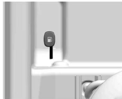
Levante la manija de la puerta del tanque de combustible del lado del asiento del conductor para abrir la puerta del tanque de combustible.
