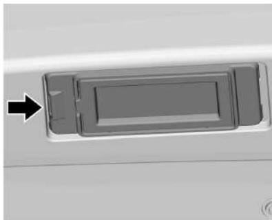
1. Separe la carcasa de la lámpara con una herramienta adecuada, con cuidado de no tirar del cable.
