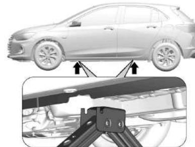
3. Ajuste el gato a la altura necesaria. Coloque el gato directamente debajo del punto de elevación, de modo que no pueda resbalar.
