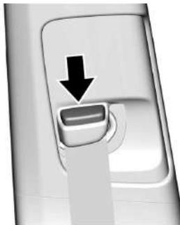
Presione el botón de desbloqueo y mueva el ajuste de seguridad a la posición deseada. El ajuste se puede mover empujando el deslizador. Una vez que el ajuste esté en la posición deseada, trate de moverlo hacia abajo sin presionar el botón de desbloqueo para verificar que se ha trabado en la posición deseada.
