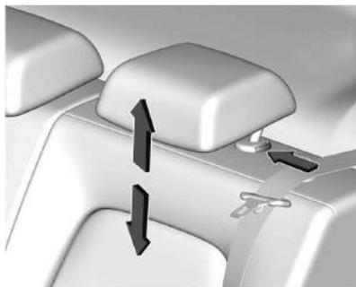
Se puede ajustar la altura del apoyacabezas. Tire del apoyacabezas hacia arriba para levantarlo. Intente mover el apoyacabezas para verificar que está trabado en su lugar.
