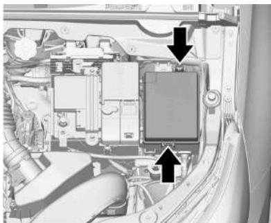
La caja de fusibles está en la parte delantera izquierda del compartimento del motor.
