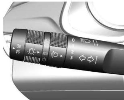
El control de las luces exteriores se encuentra en la palanca de las luces de giro.
