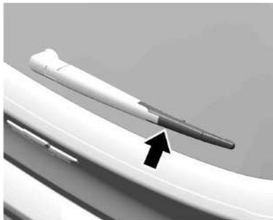
En los vehículos hatchback, levante el brazo del limpiacristal. Empuje la escobilla hacia abajo, con un leve ángulo en relación al brazo, hasta que se desenclave.
