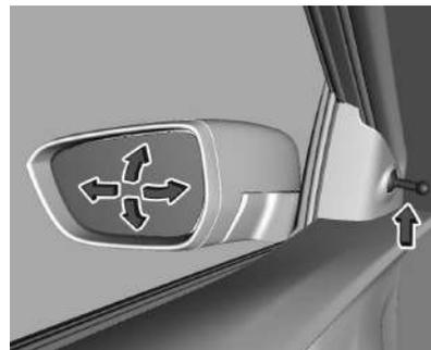
Ajustar manualmente los retrovisores externos con la palanca.
