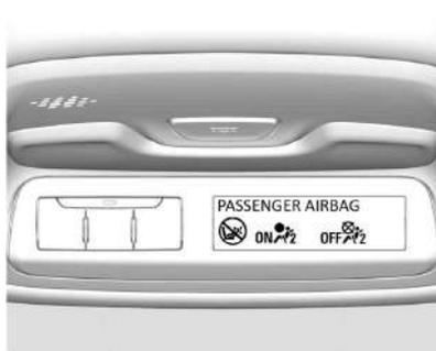
Siempre que el testigo de control
