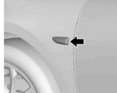
1. Separe la carcasa de la lámpara con una herramienta adecuada, con cuidado de no tirar del cable.
