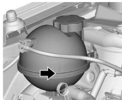
El tanque de compensación del refrigerante está ubicado en el compartimiento del motor, del lado del acompañante. Consulte *Vista del compartimiento del motor (Motor turbo L3 1.0L)* ⇨ 168 o *Vista del compartimiento del motor (Motor 1.0L L3)* ⇨ 170.
