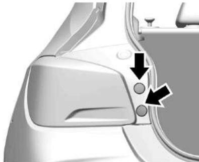
1. Extraiga y guarde los dos tornillos que fijan el conjunto de luz trasera a la carrocería del vehículo.
