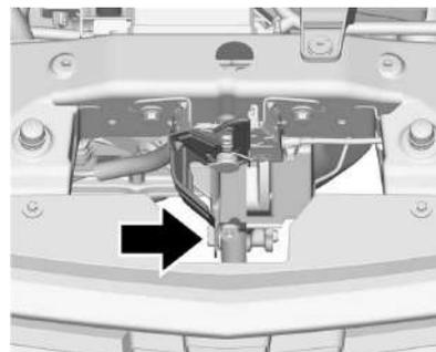
Empuje el cierre de seguridad hacia el lado del conductor y abra el capó.
