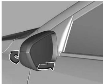
Para la seguridad de los peatones, los retrovisores externos basculan de su posición de montaje normal al recibir impactos de una determinada fuerza. Vuelva a colocar el retrovisor en su posición presionando ligeramente sobre la carcasa. Esta función también es útil para reducir el ancho total del vehículo y evitar daños cuando el vehículo está estacionado. Vuelva a colocar el retrovisor en su posición de funcionamiento antes de conducir.
