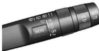
Empuje la palanca hacia adelante hasta la primera posición. El limpiaventana comenzará a barrer. Para detener el movimiento, coloque la palanca en la posición inicial.
