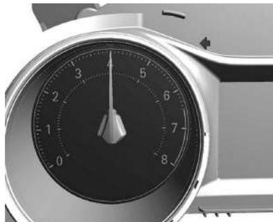
El tacómetro muestra el régimen del motor en revoluciones por minuto (rpm).
