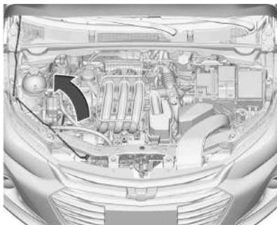
Para mantener el capó del motor abierto, inserte la varilla de apoyo en el orificio correspondiente del capó.
