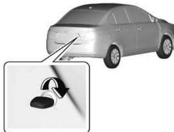
Para desbloquear el baúl, inserte la llave y gírela hacia la derecha. Levante la tapa del baúl.
