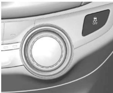
Puede desactivar el ESC para cada conducción de alto rendimiento.
