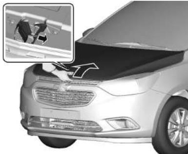
3. Libere la varilla sujetadora del capó del broche de retención. Baje la varilla e inserte el extremo libre firmemente en la cavidad del guardabarros.
