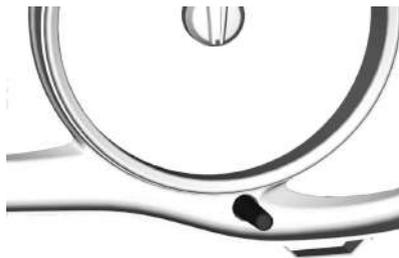
El botón de control del DIC se encuentra en la esquina inferior derecha del tablero de instrumentos. Puede pulsarlo para cambiar o restablecer las opciones del menú en la pantalla.
