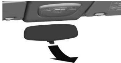
El espejo interior se puede ajustar manualmente hacia las cuatro direcciones.
