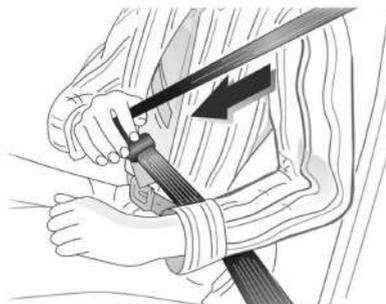
Saque el cinturón de seguridad del retractor, colóquelo alrededor del cuerpo sin torceduras, y luego abroche el cinturón. Mientras
