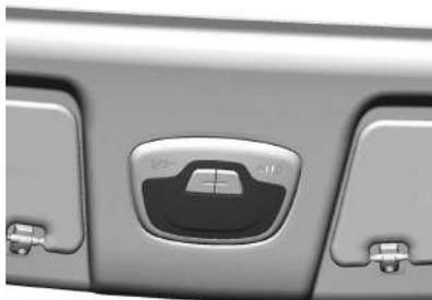
1. Utilice la parte plana de un destornillador para abrir la pantalla de vidrio haciendo palanca y sacarla del revestimiento del techo.
