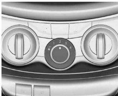
Puede controlar el volumen del flujo de aire girando el selector de control de velocidad del ventilador. Gire el selector hacia la derecha para aumentar la velocidad del ventilador o hacia la izquierda para disminuir la velocidad del ventilador.
