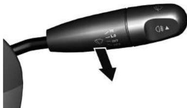
Tire de la palanca de control que se muestra en la imagen para lavar el parabrisas.
