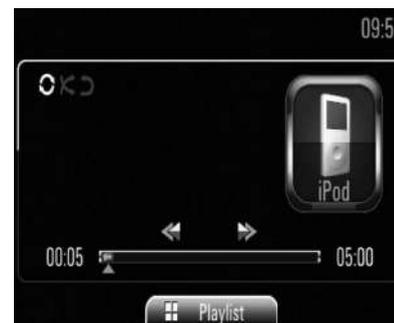
Se puede conectar un iPod al sistema de infoentretenimiento. Cuando se conecta, el iPod puede operarse mediante los mandos y menús del sistema de infoentretenimiento.
