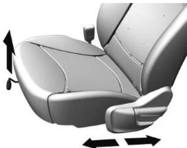
Tire de la palanca de ajuste y deslice el asiento hacia delante o hacia atrás hasta alcanzar una posición adecuada, luego suelte la palanca de ajuste. Muévase hacia adelante y hacia atrás para asegurarse de que el asiento haya quedado fijo en esa posición.
