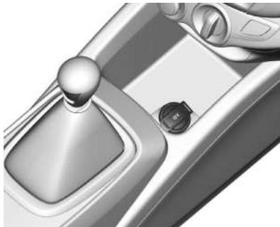
Si está equipado con un toma de tensión, el vehículo cuenta con un toma de 12 voltios que se puede utilizar para enchufar equipos eléctricos, como un teléfono móvil o un reproductor de MP3.
