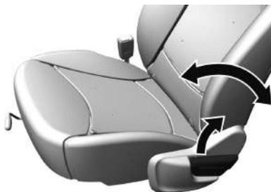
Levante la manija de liberación, ajuste la inclinación del respaldo hasta una posición adecuada y baje la manija.
