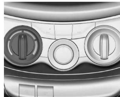
El selector de control de la climatización se usa para controlar la temperatura del aire que fluye por las rejillas de ventilación.
