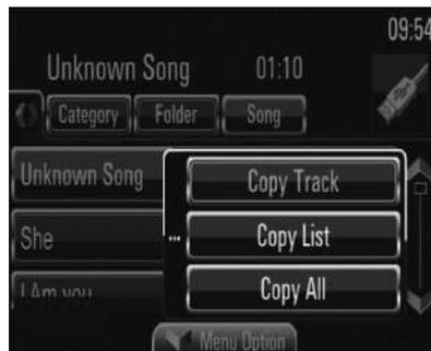
Los archivos multimedia almacenados en dispositivos de almacenamiento de gran capacidad puede copiarse en el disco duro interno del vehículo mediante el puerto USB.
