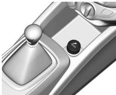
Si está equipado, el encendedor está situado en la consola delantera del piso.
