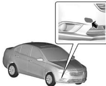
Destrate la tapa usando un destornillador y retírela. El gancho para remolque se guarda junto a las herramientas del vehículo.
