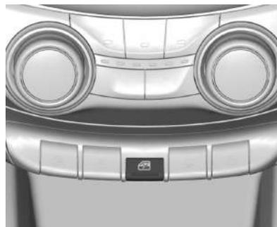
El botón de bloqueo de las ventanillas eléctricas puede desactivar los interruptores de las ventanillas traseras. Las ventanillas traseras solo se pueden operar usando los interruptores delanteros cuando se pulsa este botón.
