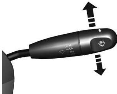
Para usar el limpiaparabrisas, primero gire el interruptor de encendido a la posición ON (ENCENDIDO), y luego empuje la palanca del limpiaparabrisas hacia arriba.
