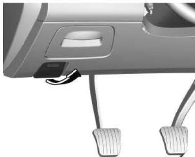
2. Empuje la palanca de la traba de seguridad hacia la derecha y abra el capó.
