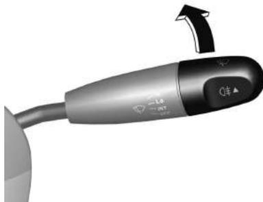
Con las luces de estacionamiento y los faros encendidos en luz alta o baja, gire la perilla que está en el interruptor de combinación hacia adelante para encender las luces
