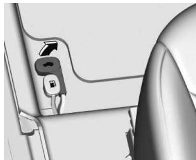
Si su vehículo cuenta con esta función, puede abrir el baúl tirando de la palanca de liberación que se encuentra sobre el piso, al lado de la esquina delantera izquierda del asiento del conductor.
