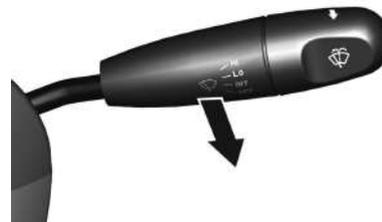
Tire de la palanca de control para pulverizar líquido del lavaparabrisas en el parabrisas y haga funcionar el limpiaparabrisas una vez.
