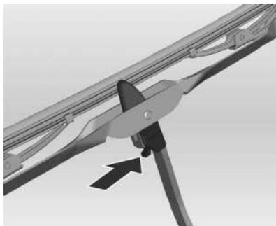
1. Mantenga presionado el sujetador de las escobillas.
