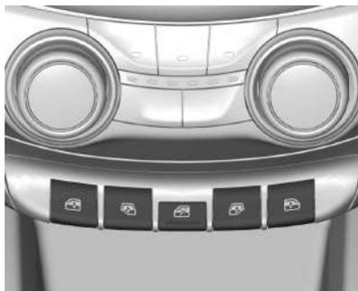
Levante el interruptor para levantar la ventanilla. Pulse el interruptor para abrir la ventanilla. Suelte el interruptor cuando la ventanilla alcance la posición deseada.
