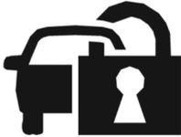
Este testigo se enciende cuando se abre una puerta. Se apaga una vez que arranca el motor. Esto indica que el testigo puede funcionar normalmente.
