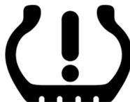
La luz de advertencia se enciende luego de que se pone en contacto el encendido y se apaga después de unos segundos. Esto indica que la luz de advertencia está funcionando correctamente.
