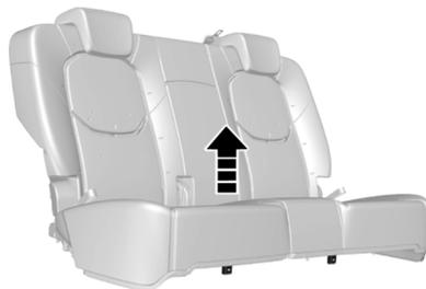
Tire levemente de la parte trasera del cojín del asiento para desbloquearlo y levántelo.
