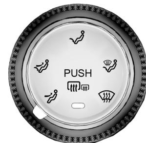
Para encender el desempañador, primero ponga en contacto el encendido y luego pulse el botón del desempañador de la luneta trasera. El testigo debajo del botón se enciende. Vuelva a pulsarlo para desactivar el desempañador. El testigo debajo del botón se apaga.
