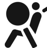
En el tablero de instrumentos hay una luz testigo de los airbags que se distingue con el símbolo con la forma de los airbags. El sistema comprobará si el sistema del circuito de los airbags tiene una falla y dará el correspondiente aviso por medio del
