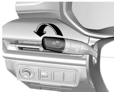
Para encender o apagar los faros, las luces traseras y las luces de estacionamiento, gire el extremo de la palanca de control del interruptor combinado.
