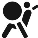
La luz de advertencia del airbag se enciende cuando se pone en contacto el encendido y se apaga después de unos segundos. Esto indica que tanto la luz de advertencia y como el sistema del airbag están funcionando normalmente.
