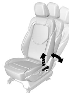
Tire la palanca hacia arriba y ajuste el ángulo de inclinación del respaldo a la posición adecuada, y luego suelte la palanca. No se apoye en el respaldo mientras lo ajusta. Luego de ajustar el respaldo, recuéstese sobre el mismo para asegurarse de que se haya trabado en su posición.
