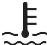
La luz de advertencia de la temperatura del refrigerante del motor se enciende cuando se pone en contacto el encendido y se apaga después de varios segundos. Esto indica que tanto el sistema como la luz testigo están funcionando correctamente.
