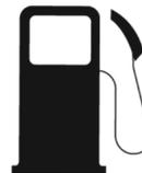
Esta luz de advertencia se enciende inmediatamente cuando se pone en contacto el encendido. Esto indica que el sistema está llevando a cabo una autoinspección y que la lámpara de la luz de advertencia está funcionando correctamente. Si esta luz permanece encendida luego de poner en contacto el encendido o se enciende mientras conduce, indica que hay insuficiente cantidad de combustible en el tanque y debería cargar combustible a tiempo.
