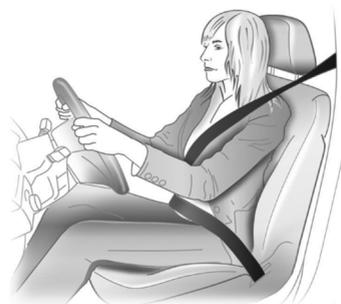
El cinturón de seguridad está diseñado para un solo pasajero. No es apto para pasajeros menores de 12 años de edad o de una estatura inferior a los 150 cm. Revise periódicamente todas las partes del sistema del cinturón de seguridad para verificar que no tenga daños y que no funcione de forma anormal. Reemplace las partes y componentes dañados. Para reemplazar o realizar un servicio a un cinturón de seguridad, consulte con su concesionario.
