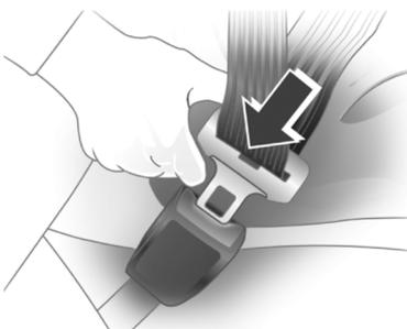
Retire el cinturón de seguridad del retractor, guíelo alrededor del cuerpo sin retorcerlo e inserte la lengüeta de bloqueo en la hebilla para abrocharlo. Para conducir, tire de la banda torácica con fuerza para ajustar la tensión de la banda de la cadera.
