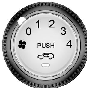
Gire la perilla de control de velocidad del ventilador para controlar el caudal de aire del sistema.
