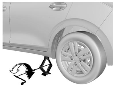
5. Gire la biela del gato hacia la derecha para permitir que el gato suba lentamente y asegúrese de que la cabeza del gato esté firmemente puesta en la posición de elevación.
