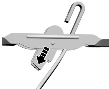
Tal como se muestra, coloque la escobilla de modo que quede perpendicular al brazo del limpiaparabrisas y luego presione la escobilla en la dirección de la flecha para separar la escobilla del brazo.
