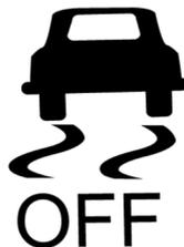
La luz de advertencia se enciende luego de que se pone en contacto el encendido y se apaga después de unos segundos. Esto indica que la luz de advertencia está funcionando correctamente.
