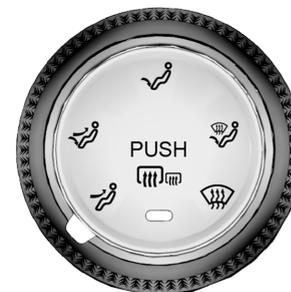
Ajuste la perilla de distribución de aire al modo deseado, de manera que el aire fluya en la dirección deseada.
