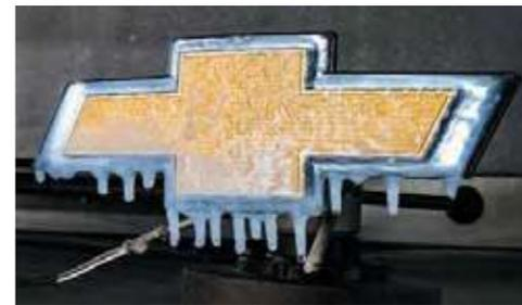
LOS EMBLEMAS BOWTIE ILUMINADOS SE CICLAN 1.5 MILLONES DE VECES, SE FABRICAN CON UNA CONSTRUCCIÓN IMPERMEABLE AL 100% Y ESTÁN APROBADOS PARA SU RESISTENCIA Y FUNCIONAMIENTO A TEMPERATURAS EXTREMAS DE -40 ° F A 158 ° F.
